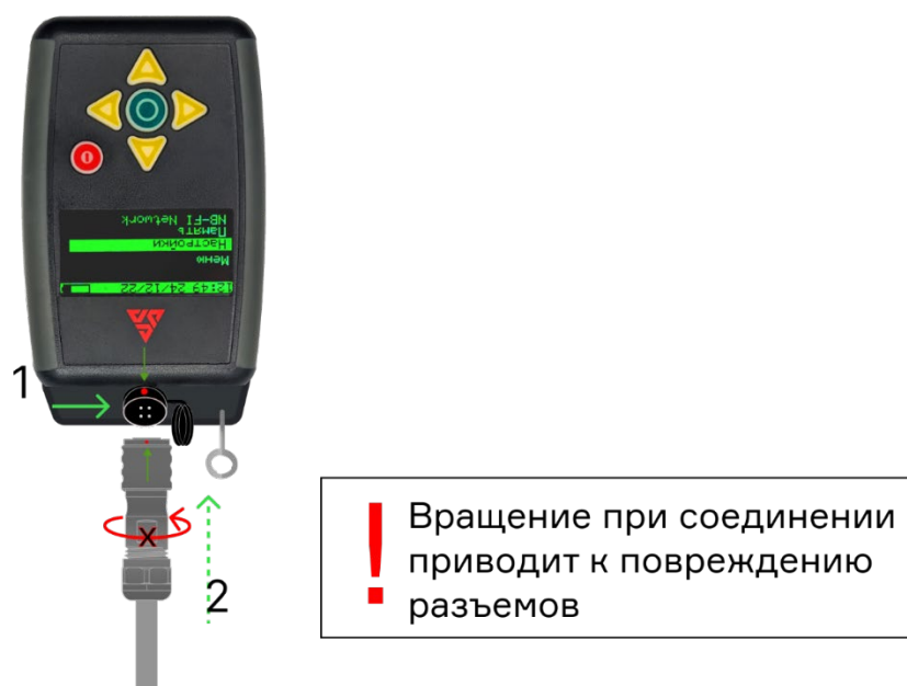
Рисунок 11. Совмещение ключей разъемов РГТ-ИТМ2 и РГТ-СТ-ХХ
