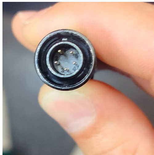
Рисунок 6. Распиновка разъема термокосы: 1 – «+5 В», 2 – «Data», 3 – «-5 В».
